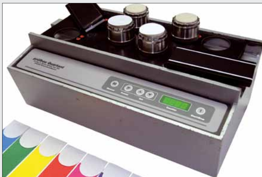
Рис. 3: Лабораторный прибор для испытания на истирание фирмы Prüfbau. Технологи Hostmann-Steinberg RUS для оперативного контроля используют портативный прибор Ugra Scheuerprüfgerät
